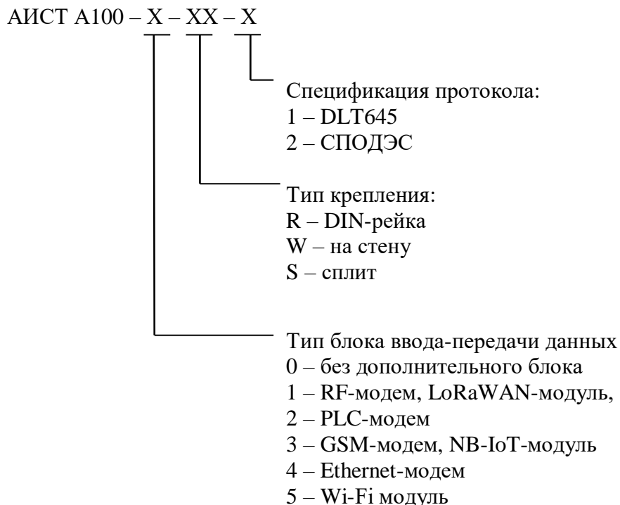
Рисунок 1. Структура условного обозначения счетчика АИСТ А100
