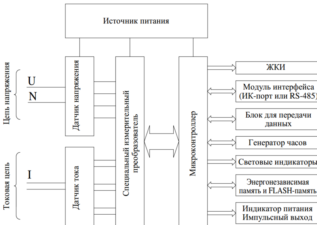
Рисунок 7 - Структурная схема счетчика
